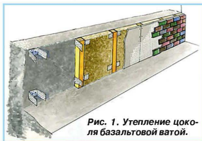
Стойки-маяки для крепления плоского шифера выравняли в вертикальной плоскости с помощью перфорированных металлических полос.
